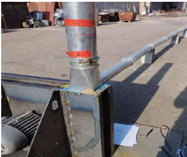
1-расм. 26 м қувурлар тизимига эга бўлган пневмотранспорт
