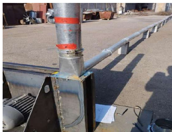
2-расм. 26 м қувурлар тизимига эга бўлган пневмотранспорт
